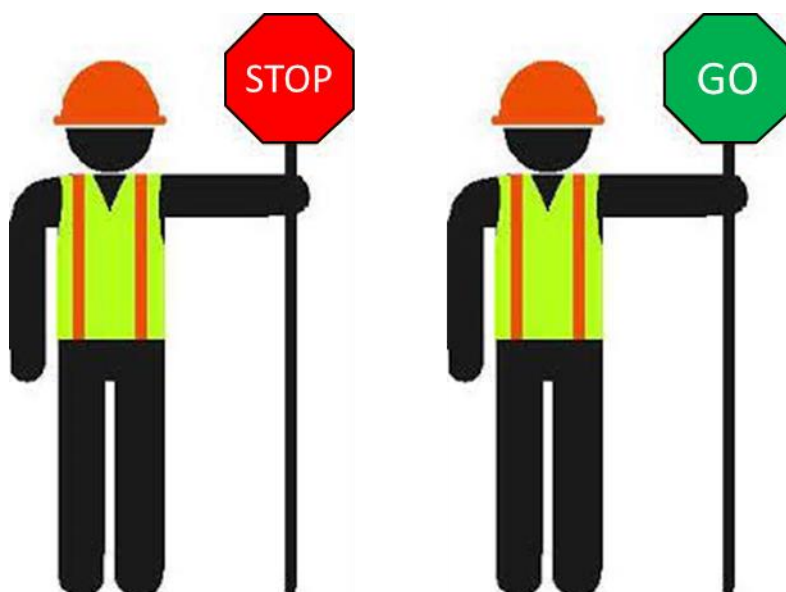
Figure 7: Mise en place d'opérateurs de signalétiques pour assurer le trafic durant tout le chantier mobile.
