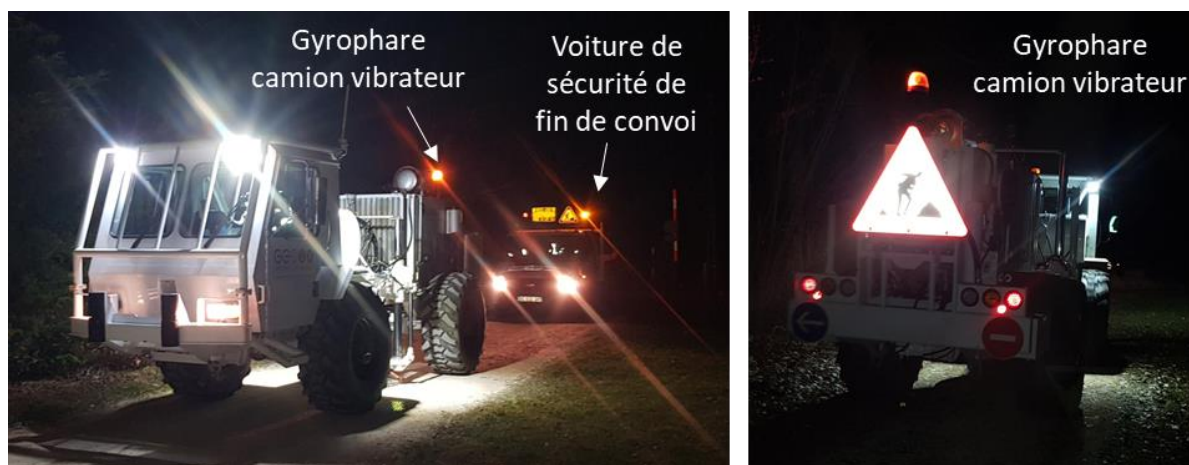
Figure 8: Exemple des moyens de signalisations lumineux mise en œuvre lors d'un chantier de mesures géophysiques. A ceci s'ajoute 2 opérateurs de signalétiques qui assureront la gestion du trafic.
