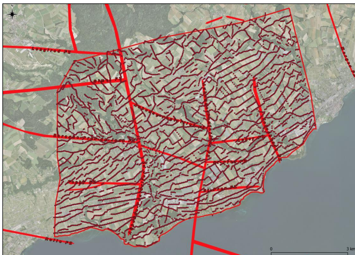
Figure 6: Carte structurale de la zone d'étude avec en overlay la grille d'acquisition des points vibrés
