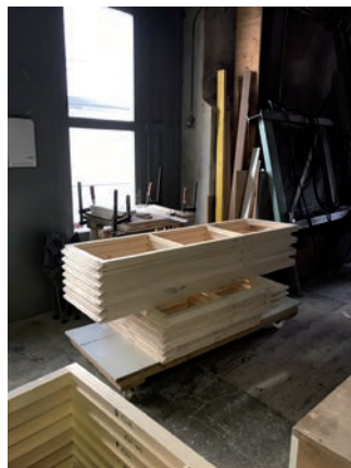
fabrication en cours des fenêtres dans l'atelier Dessaux à St-Prex
