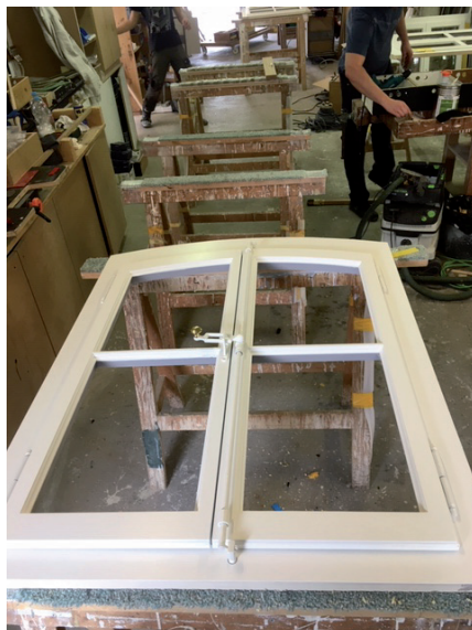
pose des ferrements et espagnolettes en atelier ainsi que du vitrage
