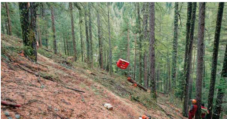
Rückarbeiten mit Mobilseilkran Zvorderscht Waldsch
