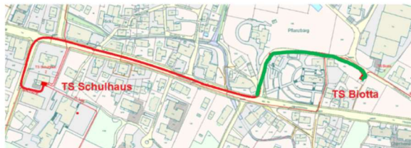
Neues Hochspannungskabel TS Schulhaus-TS Biotta Leerrohr für Hochspannungskabel in der Pflanzbergerstrasse
