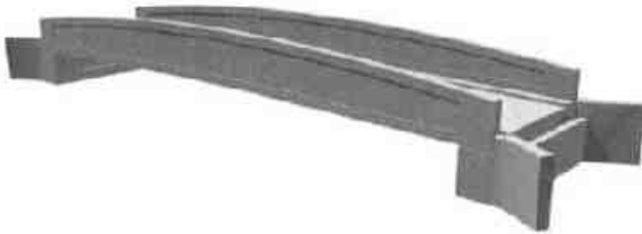
Abbildung 2: Trog-Brücke entsprechend dem Variantenentscheid des Projektteams
