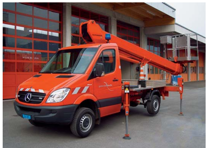
Neues Fahrzeug mit Hubarbeitsbühne.
