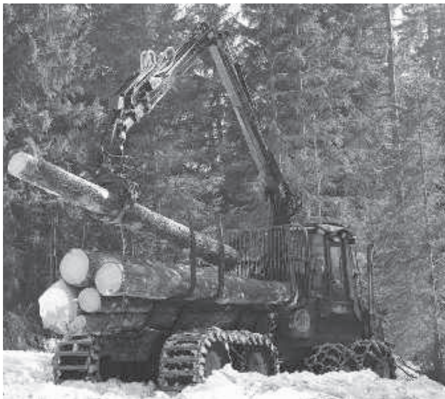
Der Forwarder ist ein geländegängiges Transportfahrzeug, das mit einem Kran bestückt ist. Bei guten Bedingungen, wenn der Boden mit einer Schneedecke geschützt ist, ist dies eine sehr effiziente Maschine.
