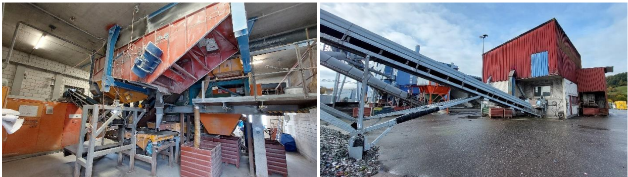
Abbildung 5: Altglasaufbereitung: Brecher (Innenansicht, Aussenansicht inkl. Förderbänder zur Produktion)
