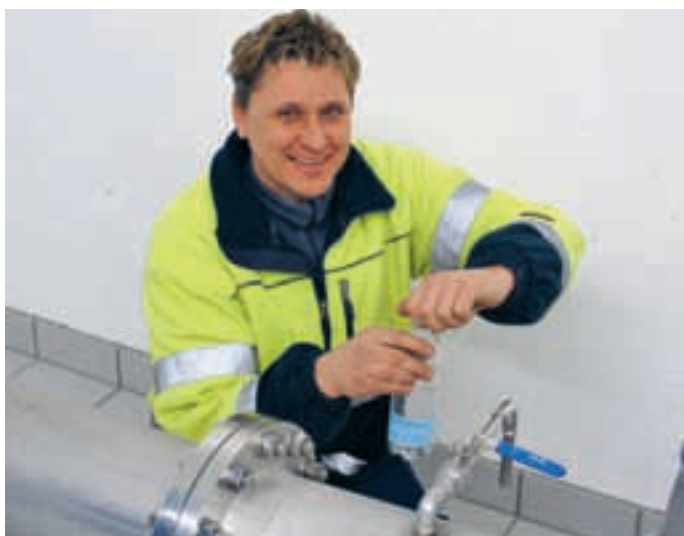
ten wir die Hydrantenleitungen Lagerstrasse und Mühleäulistrasse. Markus Jud bei der Entnahme einer Wasserprobe.
