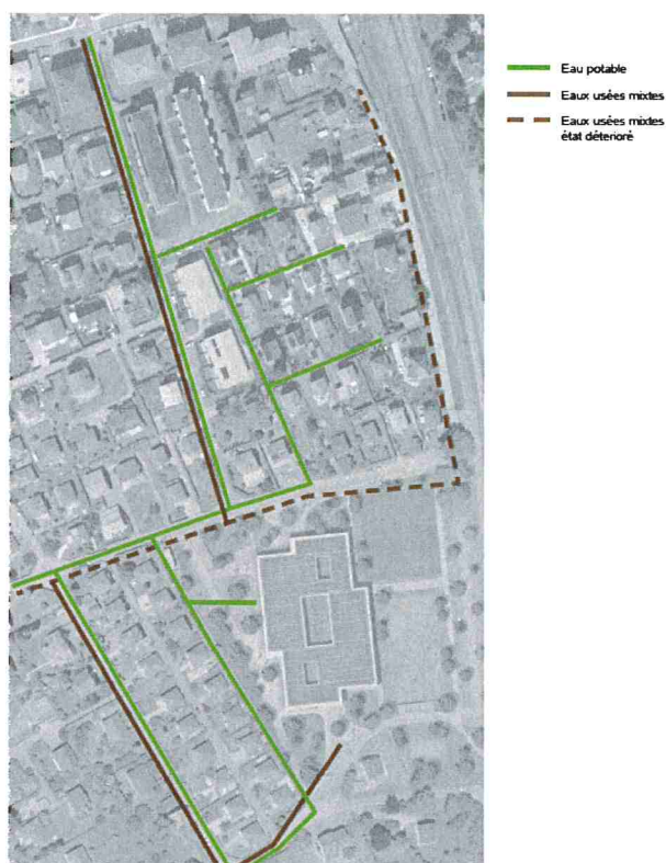
Plan des réseaux existants © Atelier Grept
