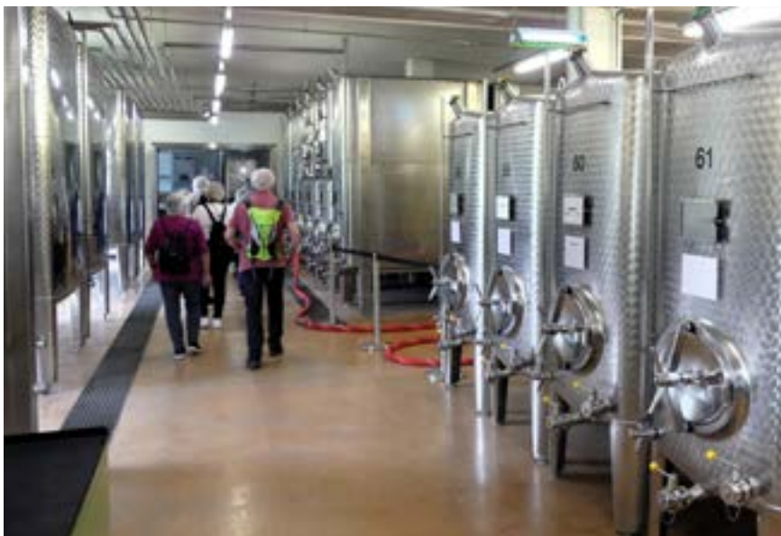
■ Die Kräuter gären unterschiedlich lange in den grossen Gärtanks, bis sie dann vom Brennmeister destilliert werden.
