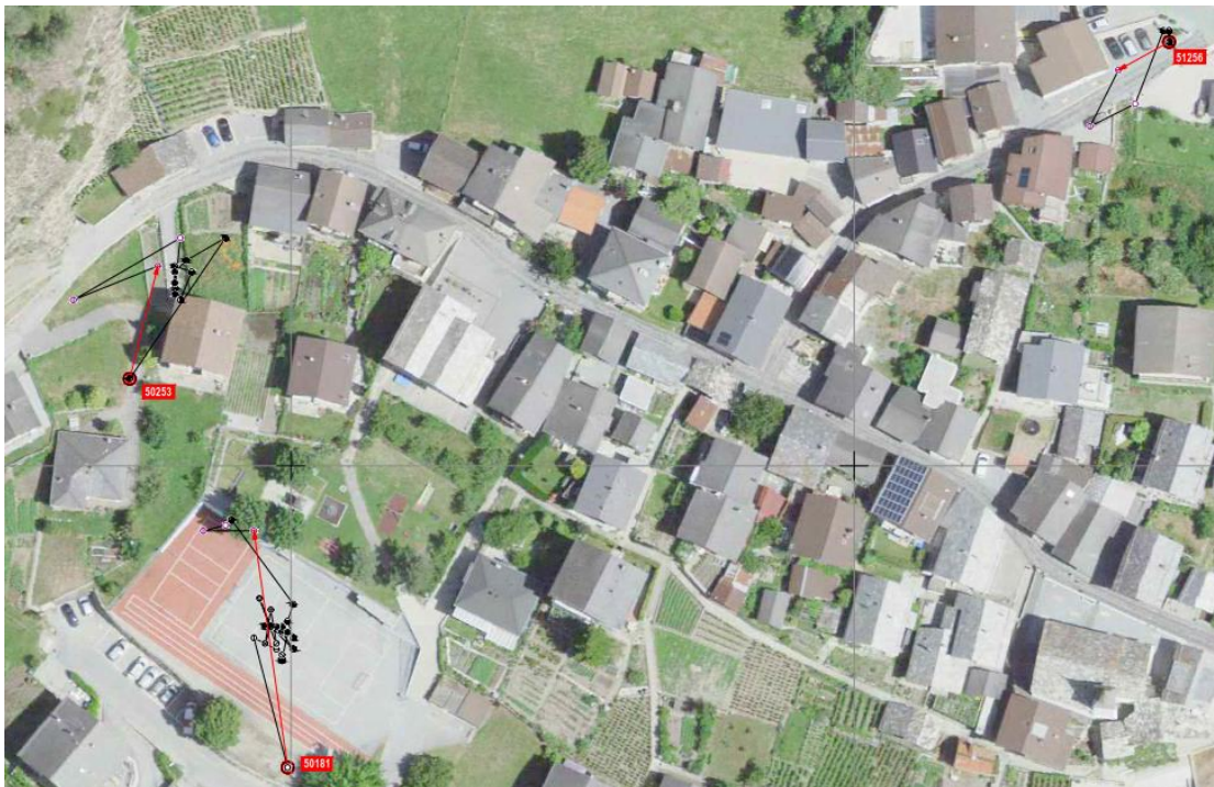
Abbildung 3: Verschiebungsvektoren Lage, Stand Okt 2020 (2495-08-F030b)
