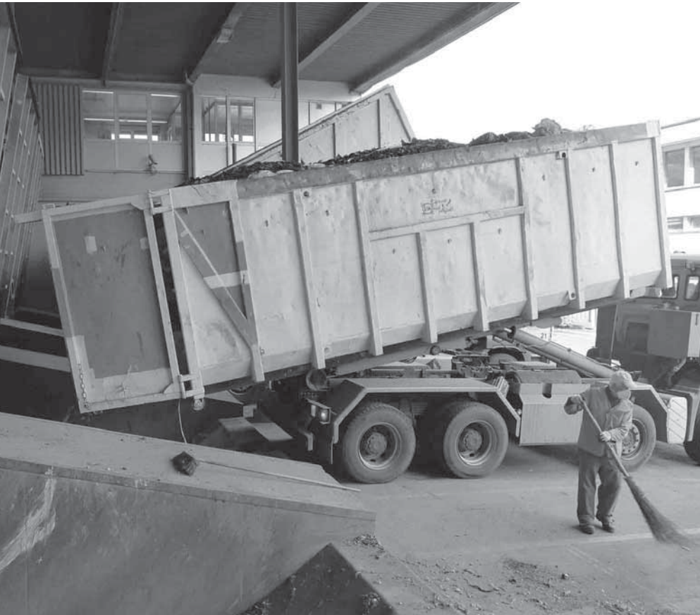
Lastwagen an Lastwagen bringen den Abfall und kippen ihn in die riesigen unterirdischen Bunker, aus denen die Öfen gespeisen werden.
