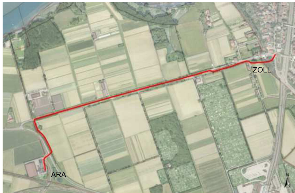
Geplanter Verlauf der beiden parallel geführten Druckleitungen
