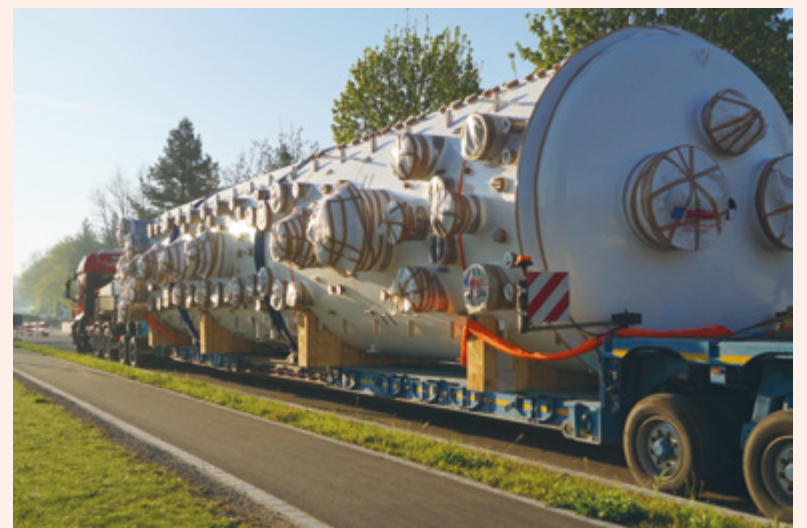
Eindruckliche 18 Meter lang war der Rohrschuss auf dem Tieflader.
