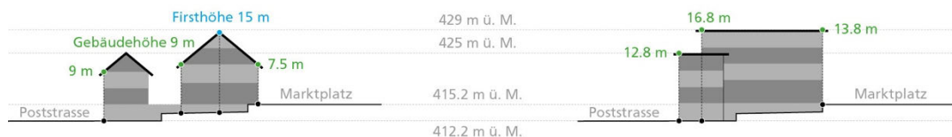
Höhenvergleich zwischen Regelbauweise nach BZO (links) und den Bestimmung im GP (rechts)
