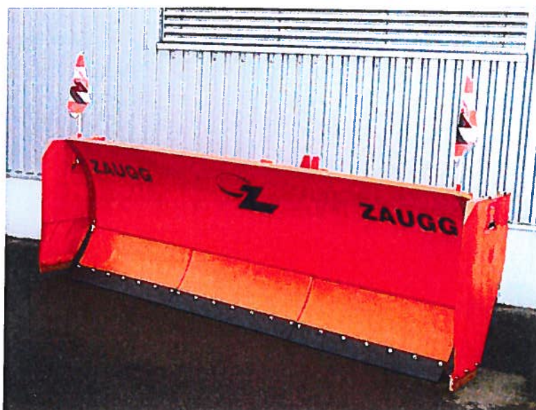
Figure 4 Lame à neige Zaugg, équipée d'ailettes rabattables
