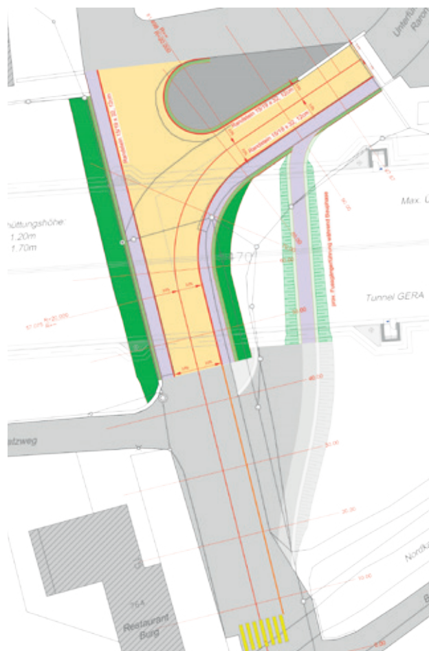
Strassenumlegung Zufahrt Bahnhof, Endzustand mit provisorischer Fussgängerführung.
