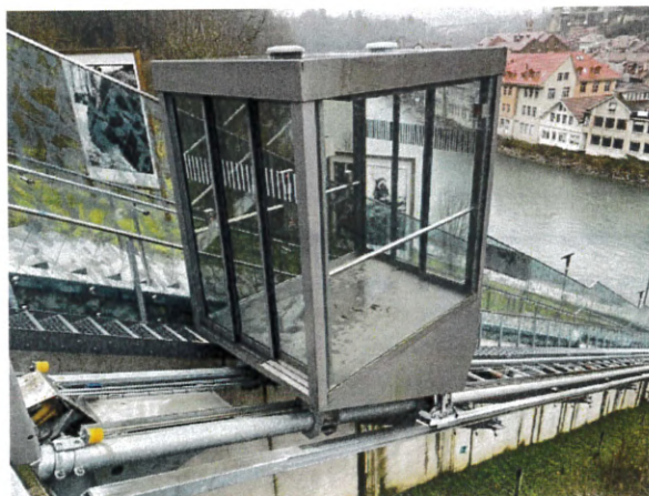
Esempio realizzativo cabina con sbarco frontale e vetri panoramici (Bärenpark, Berna)
