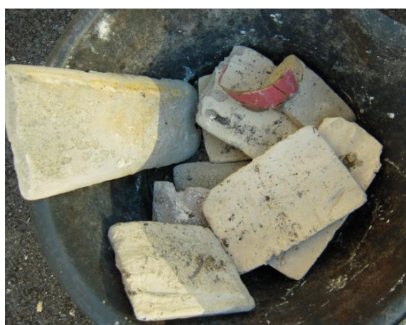
Formation de calcaires et racines retirées des conduites communales
