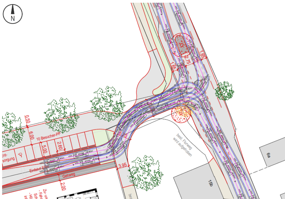
Abbildung 16: Nachweis Fahrgeometrie (VSS PW)
