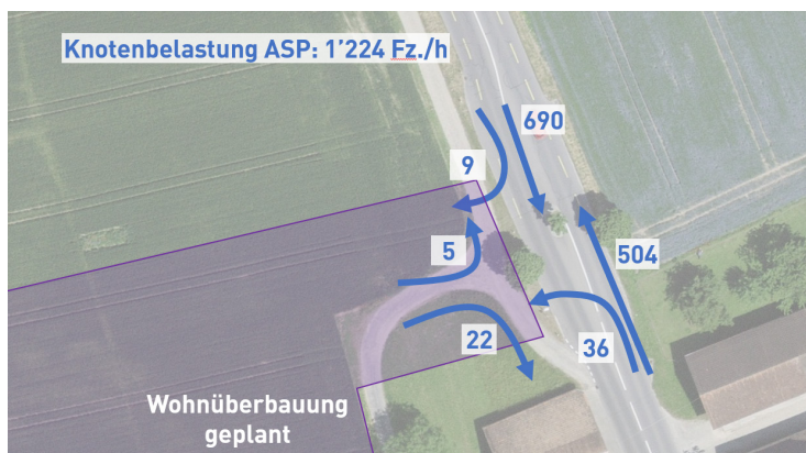
Abbildung 8: Knotenbelastung Arealanschluss in der Abendspitzenstunde
