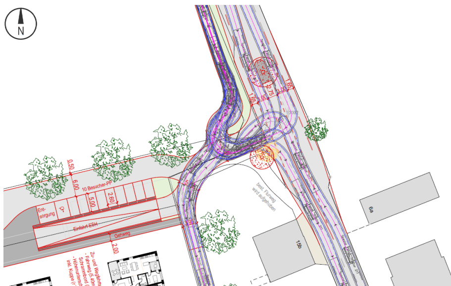
Abbildung 18: Nachweis Fahrgeometrie (landwirtschaftliches Fahrzeug mit Anhänger)
