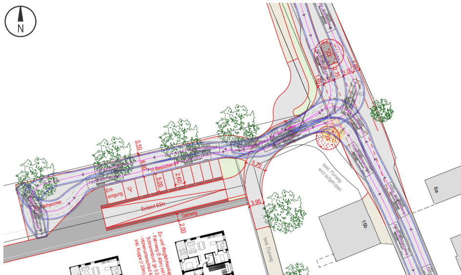
Abbildung 17: Nachweis Fahrgeometrie (FGSV Müllabfuhr)
