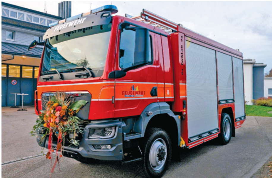
Unser neues Tanklöschfahrzeug. Ausgestattet unter anderem mit 2'500 l Wassertank, leistungsstarker Pumpe, Atemschutz-, Schlauch- und Pioniermaterial zur Brandbekämpfung und technischen Hilfeleistung
