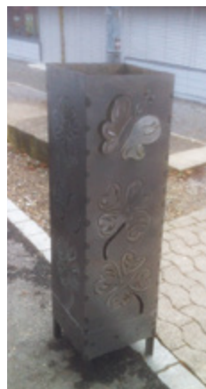
Mittels einer Plasma-Schneidanlage sind diese feinen Ornamente an der Feuersäule entstanden.
