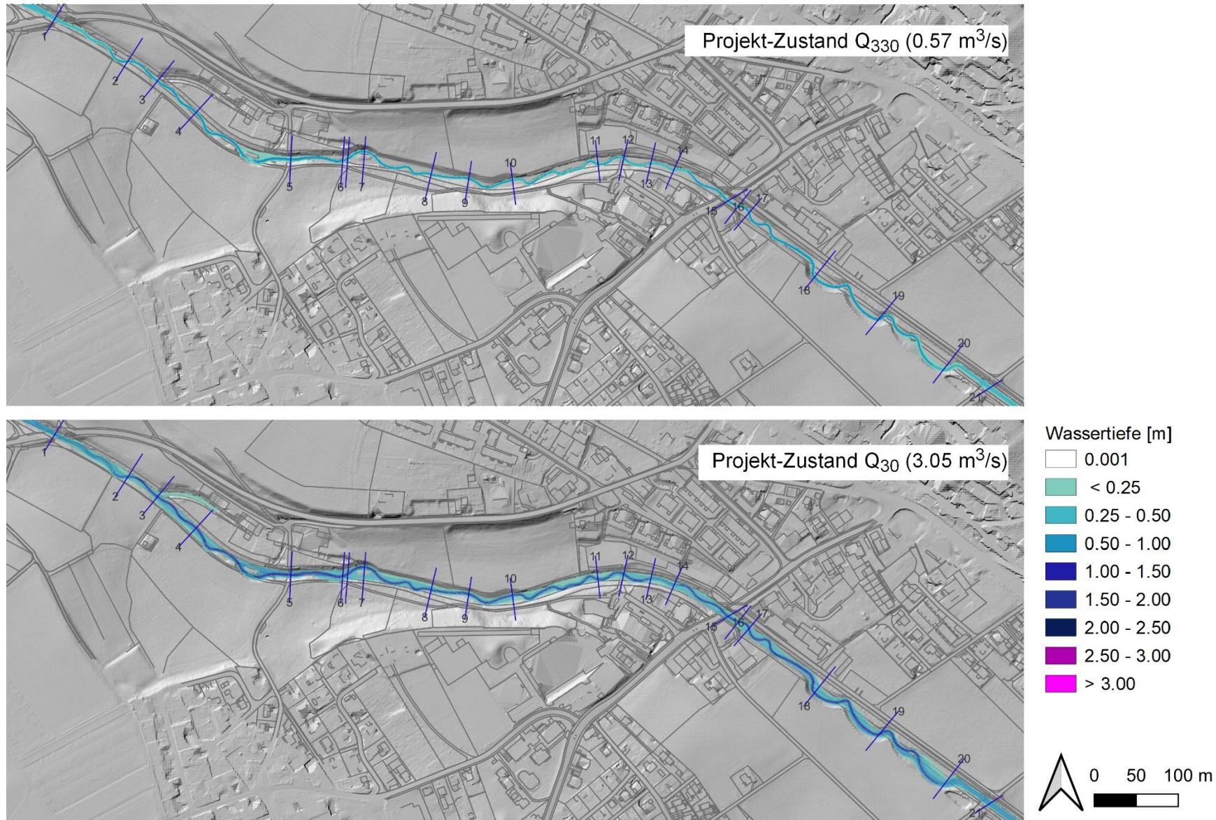
Abb. 20: Wassertiefen bei Q_{330} und Q_{30} im Projektzustand.
