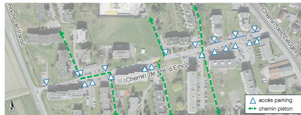
Figure 14 – Principales contraintes au réaménagement du chemin
