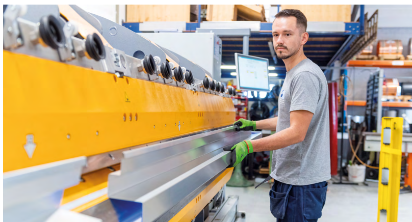
Spenglerpolier Dominic Schmid fertigt in der Werkstatt massgeschneiderte Blechprofile.
