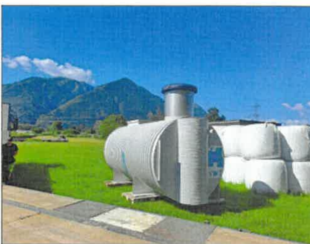
Foto 2: Nuova camera di accumulo
