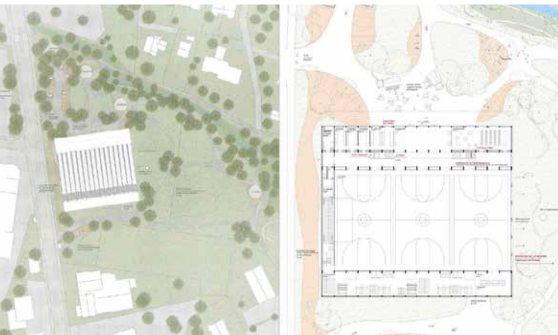
Abbildung 3: Situation und Grundriss Erdgeschoss Mehrzweckhalle
