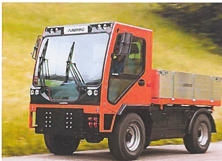
Figure 2: Véhicule Type Ladog 1550 T N. B. En lieu et place de la benne standard, le véhicule à commandé sera équipé d'une structure multi-bennes
