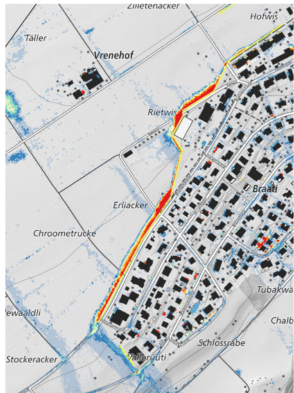
Abbildung 55: Wassertiefen bei Variante West nach 12 Minuten Simulationsdauer.
