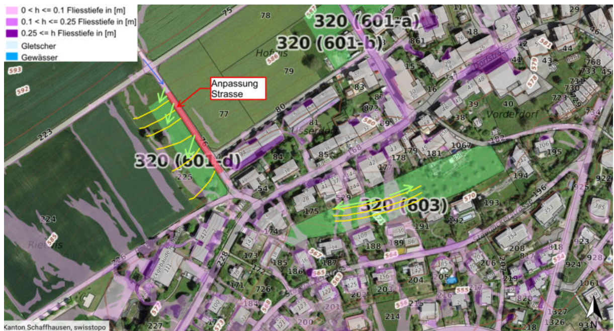
Abbildung 36: Keyline Design, im Häaldili und Rietwies (grüne Pfeile neue Fliesswege, blaue Pfeile bestehende Fliesswege, gelbe Linien Keyline Design) [1]
