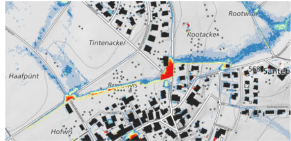
Abbildung 53: Wassertiefen bei Variante Nord nach 12 Minuten Simulationsdauer.
