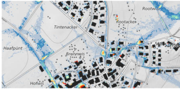
Abbildung 52: Wassertiefen im Gebiet Nord ohne Massnahmen nach 12 Minuten Simulationsdauer.
