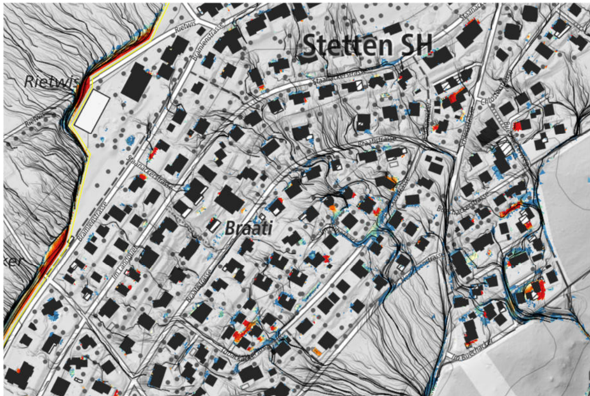
Abbildung 65: Stromlinien und Fliesstiefen im Siedlungsgebiet nach 20 Minuten Simulationsdauer.
