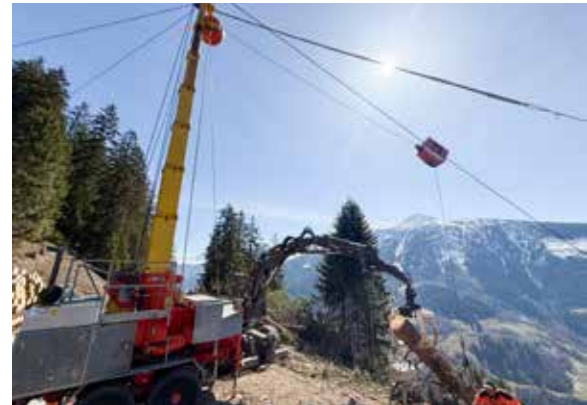
Cun la suga mobila vegn la lenna runada sper via, cun agid digl excavatur forestal luvrada si e rasenada
