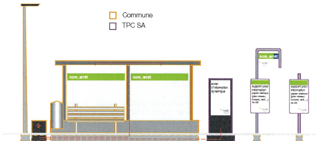
Figure 3 : Schéma d'équipement et des propriétés pour les arrêts de catégorie A
