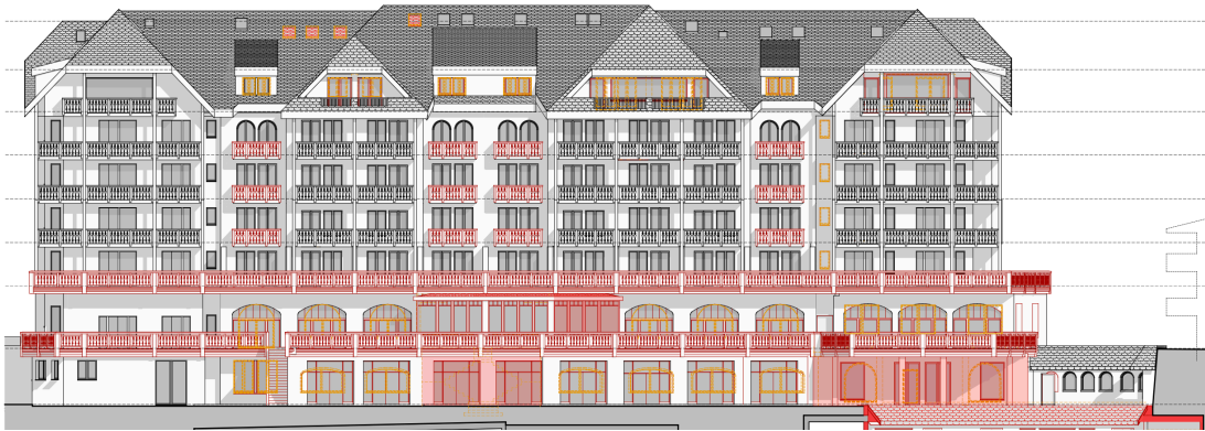
Abb. 16 Ansicht Südfassade mit der bestehenden Dachgestaltung bestehend aus Querbauten und Dachaufbauten (Giebellukarnen, Schleppgauben) (Quelle: Jaggi Architektur, Juli 2022)
