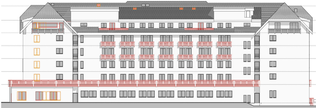
Abb. 17 Ansicht Nordfassade mit der bestehenden Dachgestaltung bestehend aus Querbauten und Dachaufbauten (Kombination aus Flachgaube und Schleppgaube) (Quelle: Jaggi Architektur, Juli 2022)
