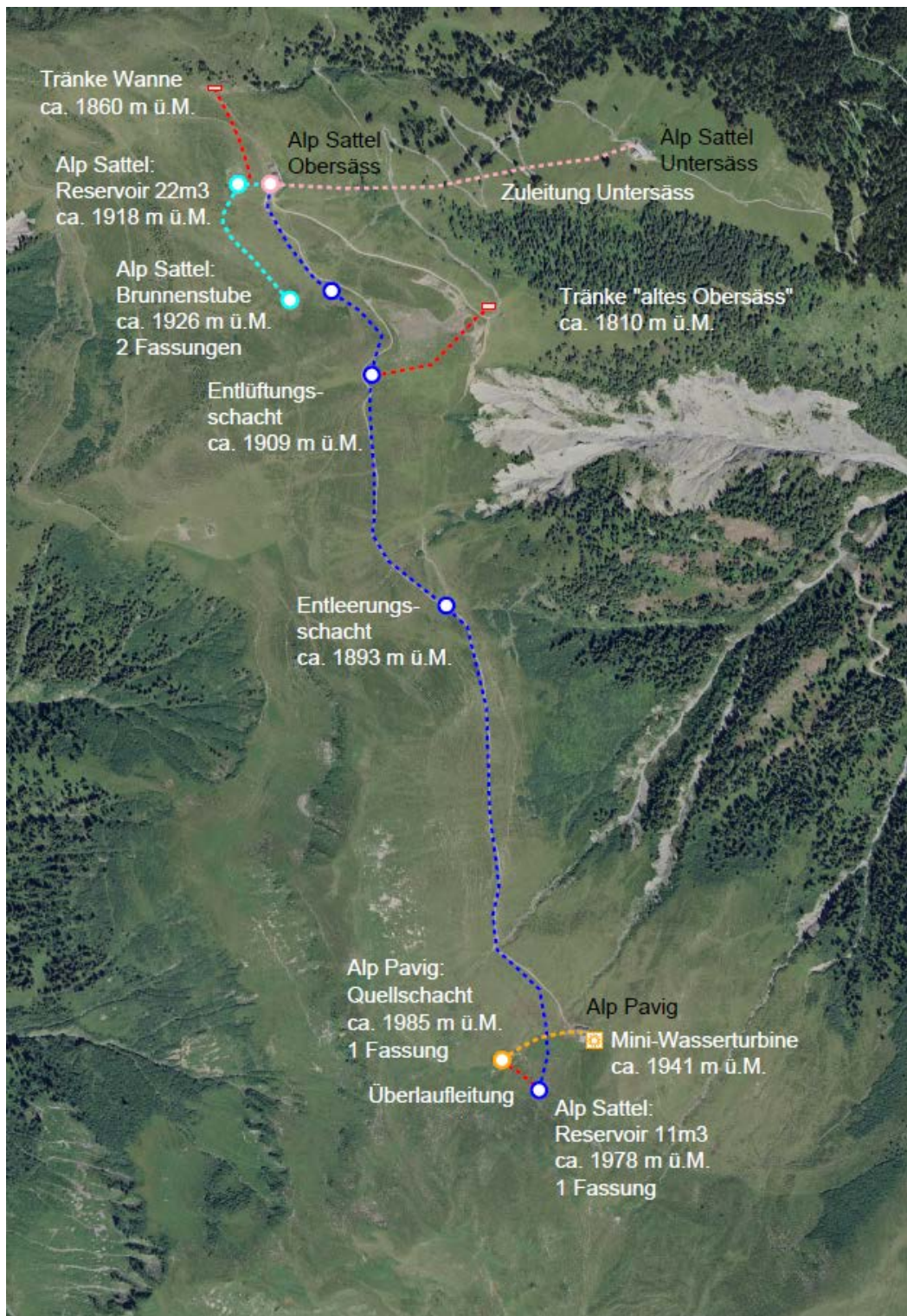
Übersichtsplan der Wasserversorgungsanlagen
