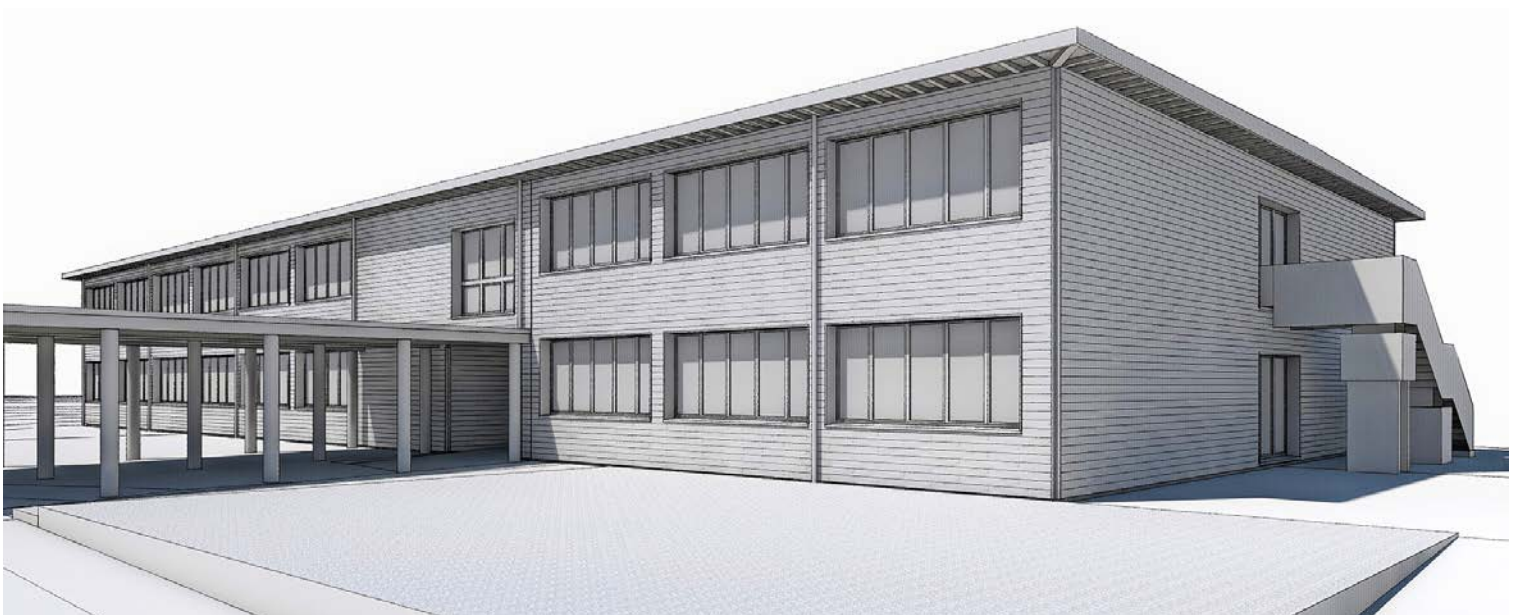
An der Nordseite des Schulhauses wird der Bau um vier Räume verlängert. Das geplante Untergeschoss entfällt aus Kostengründen. Die Architektur des neuen Traktes fügt sich nahtlos an den bestehenden Bau an.
