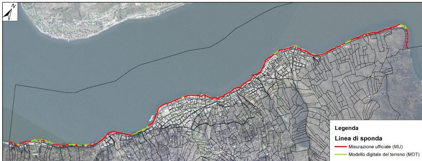
Fig. 1 Linea di sponda del lago Ceresio sul Comune di Brusino Arsizio, definita sulla base dei confini catastali della MU (in rosso). In verdi i tratti nei quali la linea della sponda è stata adeguata alla quota di riferimento 271.20 estrapolata dal MDT, discostandosi dal confine catastale secondo MU
