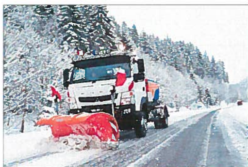
Mitsubishi Fuso Canter 4x4, modèle 6C18 équipé pour le service hivernal
