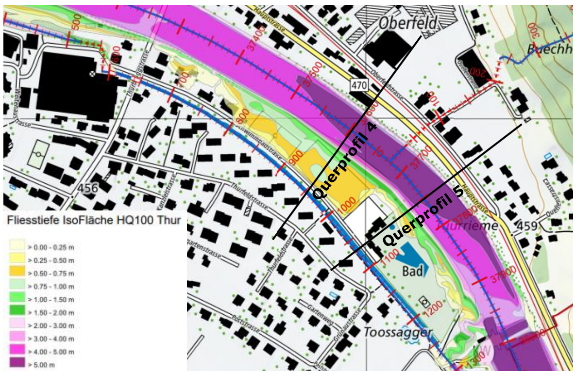
Abbildung 11: Fliesstiefe Abschnitt 3 bei HQ100 [11]. Rechtsseitig der Thur ist das Volleyballfeld und die Sportplätze von einer Fliesstiefe bis 2 m betroffen. Zwei Gebäude an der Schwimmbadstrasse sind von einer Fliesstiefe bis 0.75 m betroffen.
