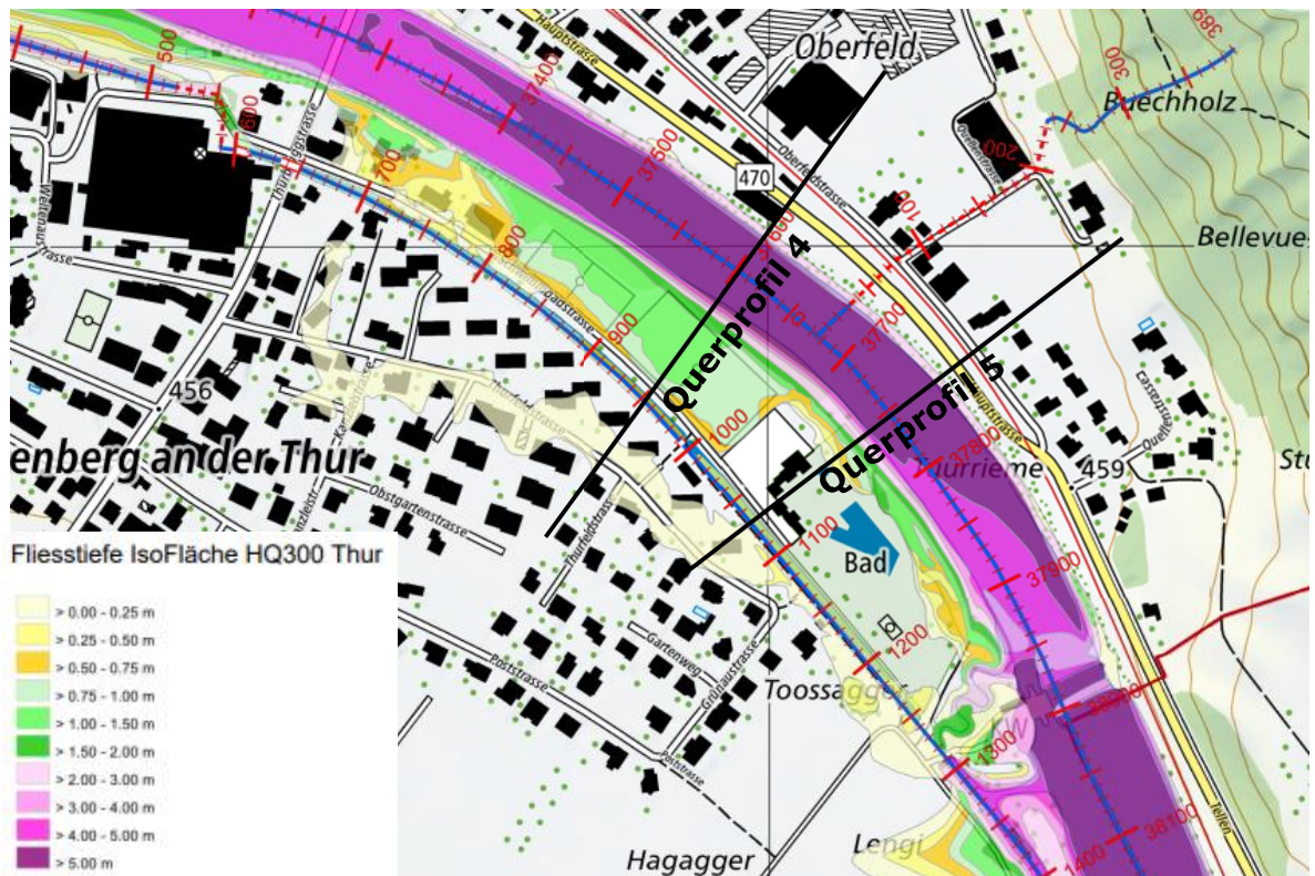
Abbildung 12: Fliesstiefe Abschnitt 3 bei HQ300 [11]. Die Ausdehnung der Überflutungsflächen und der Fliesstiefen sind vergleichbar mit jenen bei HQ100. Rechtsseitig der Thur ist das Volleyballfeld und die Sportplätze von einer Fliesstiefe bis 2 m betroffen. Zwei Gebäude an der Schwimmbadstrasse sind von einer Fliesstiefe bis 0.75 m betroffen.
