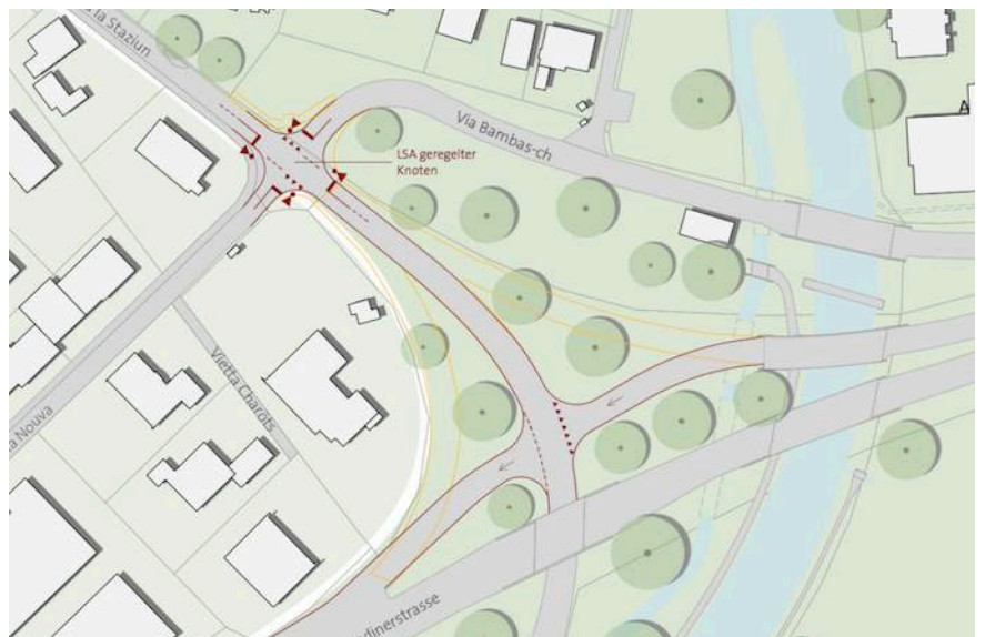
Abb. 31 Anschluss Engadinerstrasse, Variante Lichtsignalanlage
