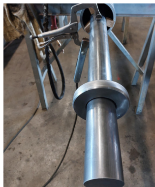
Rotorwelle 2200 mm angefertigt
