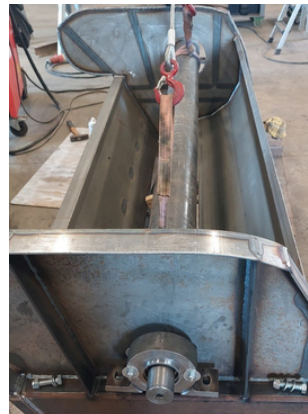
Einpassen der Rotorwelle in das Gehäuse des Mulchers
