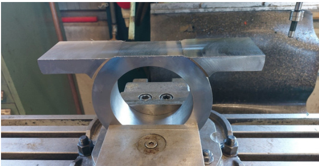
Lagerböcke geschweisst, gedreht und gefräst
