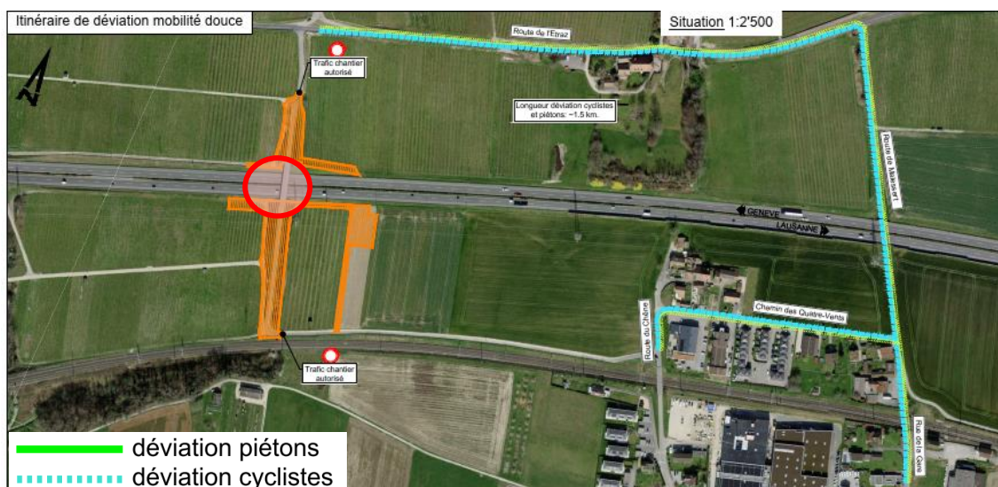
Figure 17: Situation déviation piétons et cyclistes passages sur la route nationale
