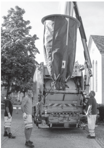
Hebung eines Unterflur-Sackbehälters mit Kran
