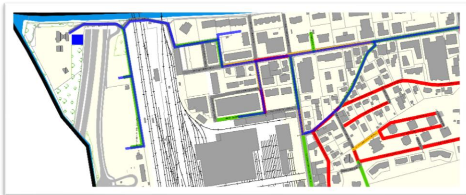
Abbildung 12: Variante 3 – ARA-Wärmeverbund (Leitungsführung)
