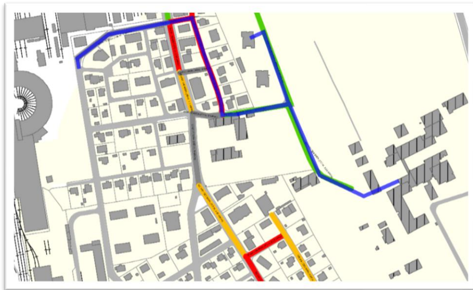
Abbildung 8: Variante 1 - GEVAG Klein-Wärmeverbund (Leitungsführung)
