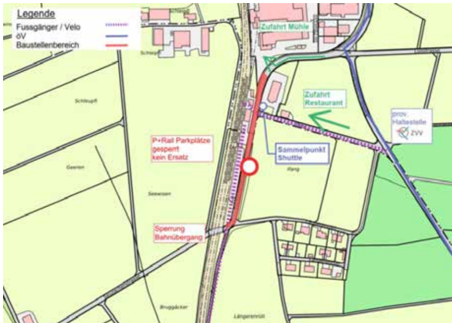
Planausschnitt mit dem Baustellenbereich.
