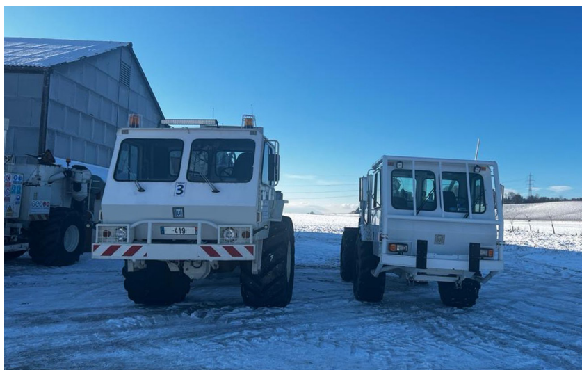
Zwei verschiedene Fahrzeugtypen werden für die Messungen eingesetzt. Ausserorts die schweren Fahrzeuge (links, ca. 25 Tonnen), in besiedelten Gebieten die leichten Fahrzeuge (7.5 Tonnen) mit reduzierter Vibrationsstärke.
