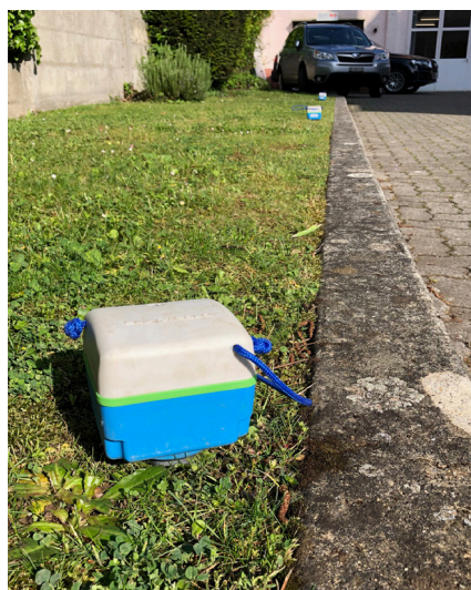
Etwa 2'700 dieser kleinen Geophone werden im Untersuchungsgebiet ausgelegt. Sie zeichnen die Vibrationswellen auf.
