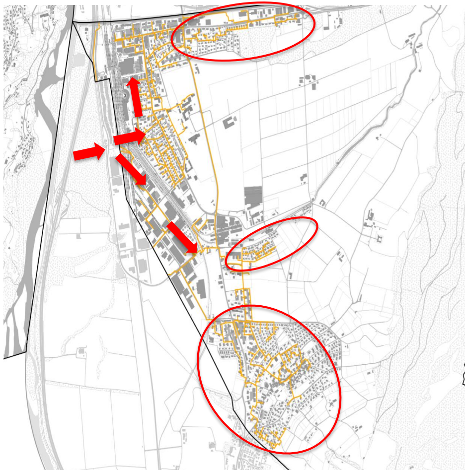
Abbildung 5: Bestehendes Gasnetz gemäss Katasterplan (2018). Die roten Pfeile zeigen die Hapterschliessung und die roten Ellipsen die Peripheriegebiete des Gasnetzes.
